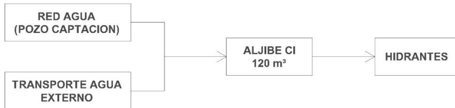
Cuando es posible que un incendio potencial adquiriera unas dimensiones importantes, que requieran labores de extinción con agua en grandes cantidades y/o desde el exterior de los edificios, se recurre a las instalaciones de hidrantes instalados en el exterior de los edificios o en áreas y vías de uso público.
