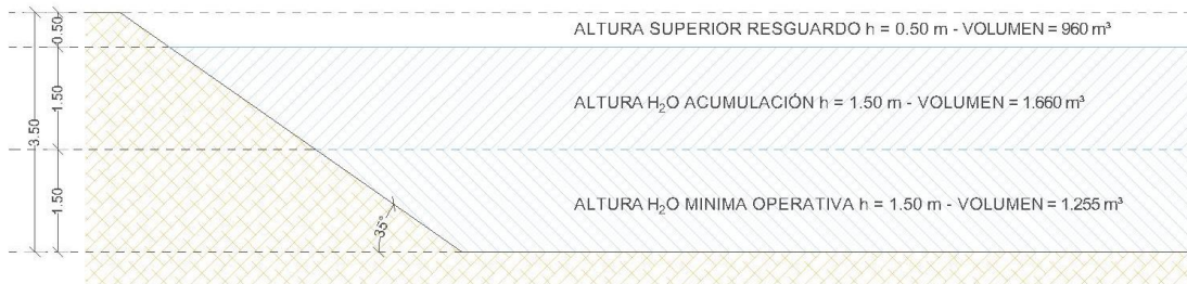
BALSA AIREACION AGUA REGENERADA
