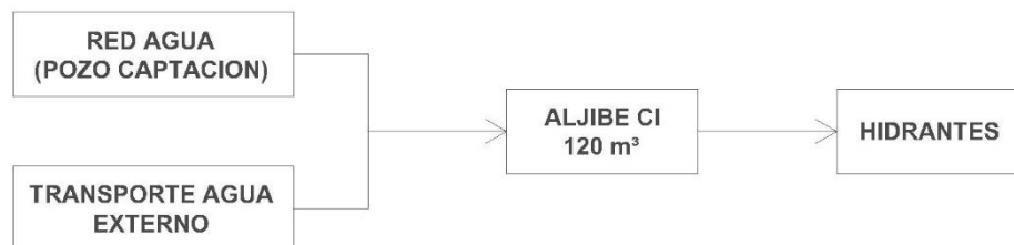
Figura 8. Esquema red de agua contra incendios
