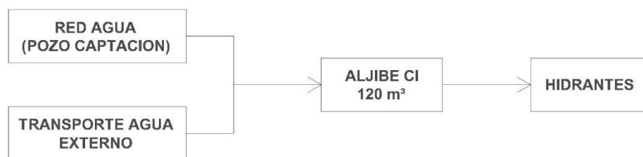
Figura 10. Esquema red de agua contra incendios
